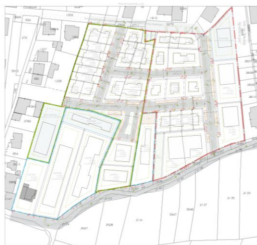
Figura 3 - Tavola delle urbanizzazioni e delle reti di progetto: viabilità, rete acque bianche, rete acque nere, rete idrica e illuminazione pubblica.
