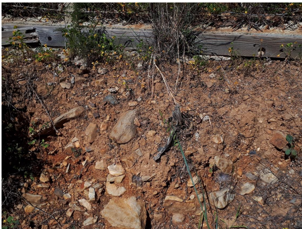
Figure 24a e 25b – Particolare delle ghiaie addensate della formazione PVM2a in sito
